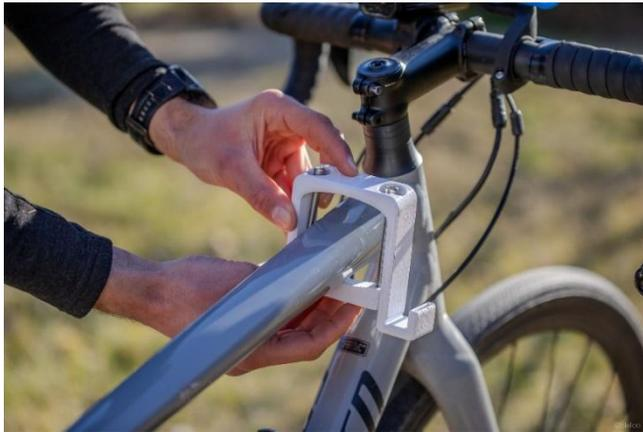
3. Se munir de la partie basse de la pièce avant. Aligner les vis en face des deux écrous.
